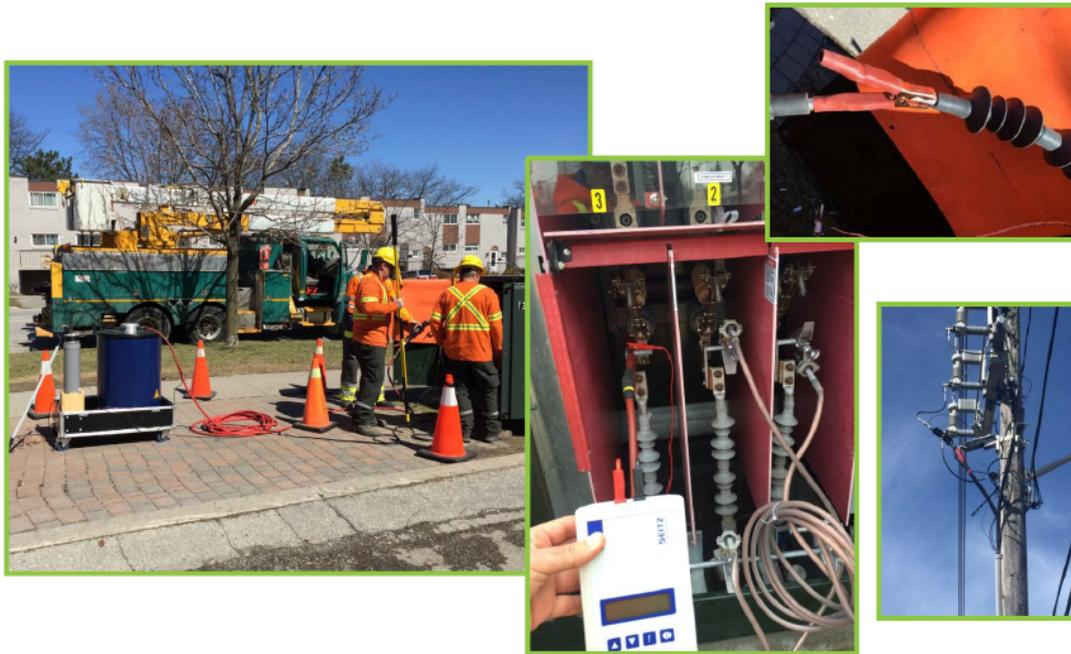
Sistema DAC mobile compatto con scariche parziali e perdite dielettriche per testare cavi di potenza MT fino a 36 kV.
