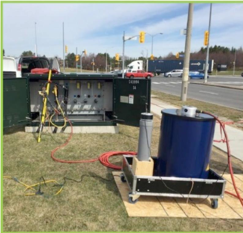
Test diagnostici di cavi di alimentazione a 27 kV impiegando DAC con misurazioni PD
