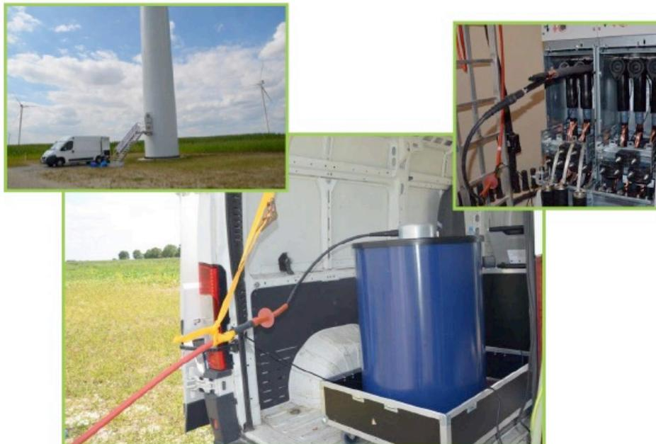
Il collaudo presso il sito di installazione con il sistema DAC compatto MV consente di testare e diagnosticare tutti i tipi di cavi MT con diverse applicazioni.
