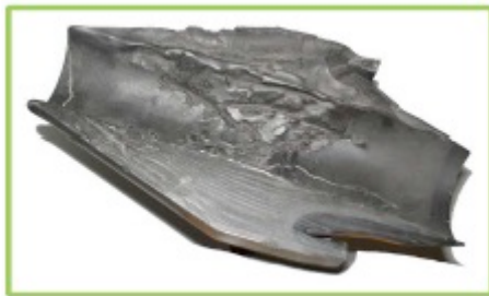
Tracce di effetto valanga sui cavi da 110 kV.
